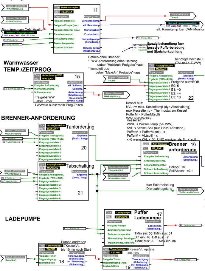
A7=Input fuer PID, nicht angeklemmt. A6 soll drehzahlgeregelter Ausgang sein. Konflikt bei Benutzung von A6??
